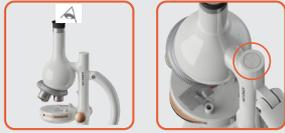
**Fall 1:** Das Präparat auf dem Objektträger befindet sich nicht direkt unter dem Objektiv
