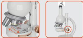
1. Vergewissere dich entsprechend der Vorgehensweise von Antwort 1, dass du das Untersuchungsobjekt mit dem Objektiv mit der niedrigsten Vergrößerung (4X) deutlich sehen kannst.
